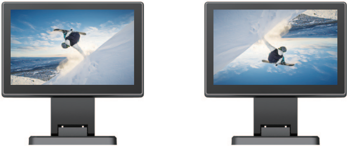
反転表示機能で設置方法に合わせた映像表示
