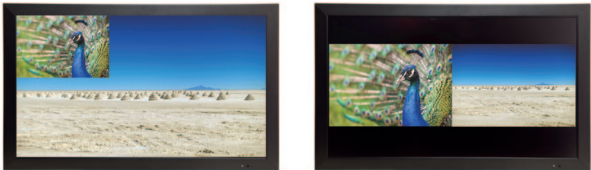
ピクチャーインピクチャー（PinP）機能・ピクチャーバイピクチャー（PbyP）機能で2つのソースを同時表示
