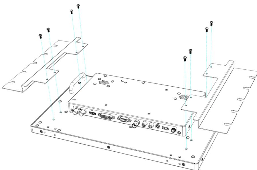
① モニター本体の背面左右にあるブラケット穴に位置を合わせて、プラスドライバーでしっかりと固定してください。
