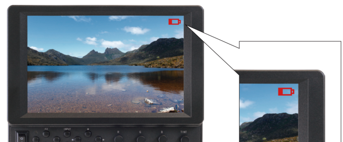
接続したバッテリーパックの残量が少なくなると画面右上に警告アイコンが点滅表示
