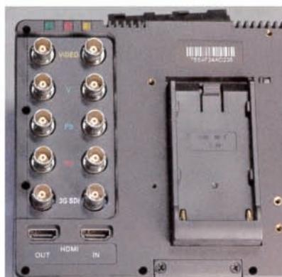
▲入力した信号をそのままスルー出力できる端子類を装備。裏面中央にソニーJバッテリーユニット用プレートがある。VマウントやアントンバッテリープレートをマウントできるVESA規格に対応する。取付ネジ穴もある。
