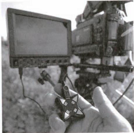
▲別売コントローラー・NW76N-RMT/3,981円（税抜）でファンクション1～4を呼び出して遠隔操作（有線＝USB接続）ができる。ボタンに触るだけで割り当て機能が表示されるので便利。
