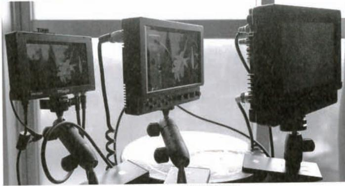
▲中央が今回のCL76SDIN、左がTV LogicのVFM-056W、右がパナソニックBT-LH80W（生産完了）。全機種をだいたい同じ明るさに調整後、斜めからチェック。パネル自体の視野角の広さ（上下左右各178°）がよく分かる。このテストでは同条件比較のために輝度を下げているのでCL76SDINは標準ではもっと明るい。
